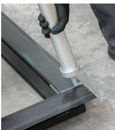
07 Coloque la cola en todas las uniones
