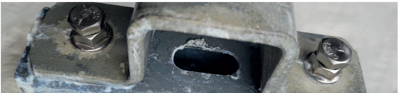
Probetas de accesorios a 1.0000 horas en NSS
