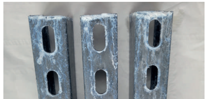
Probetas a 1.000 horas en NSS
