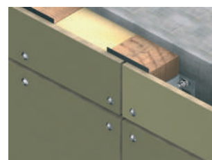
Fibrocemento sobre madera.
